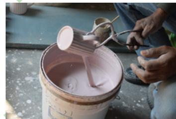
Nach dem ersten Brennen wird die Keramik glasiert und noch einmal bei hoher Hitze gebrannt. Dabei entsteht die Farbgebung.
