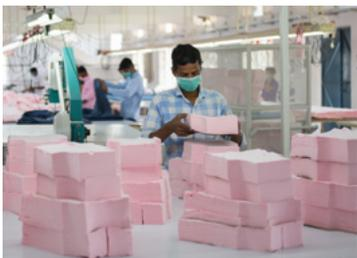
In der Näherei erfolgt nach einer Qualitätskontrolle der manuelle oder maschinelle Zuschnitt.
